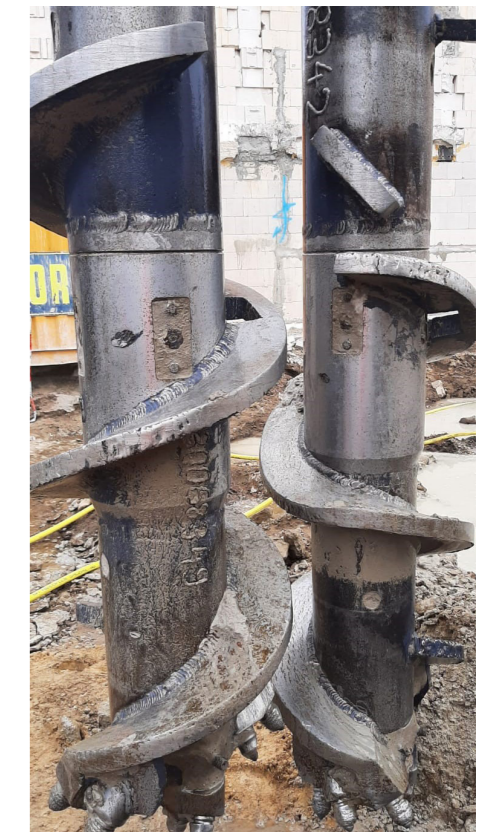
Beispiel für Schneckenanfünger und Mischwerkzeug.
