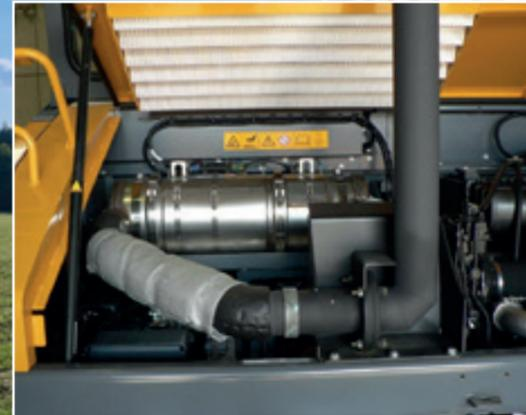
Dieselpartikelfilter DPF im Radlader Volvo L150 und im Asphaltfertiger Vögele Super 1900-3i
