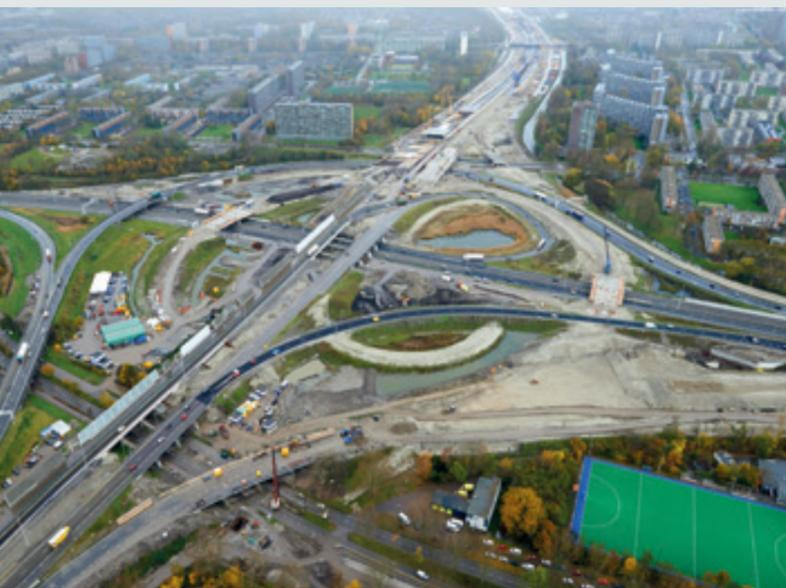
Heijmans realisiert in Arbeitsgemeinschaft das Projekt „A 4 Delft-Schiedam“ auf einer Länge von ca. 7 km. Mitbeauftragt sind ein Landtunnel von 2 km Länge mitsamt technischer Tunnelausstattung, ein Aquädukt und eine Grünbrücke (Wildbrücke), weitere diverse Brückenbauwerke, Lärmschutzwälle mit einer Gesamtlänge von 12 km sowie der Umbau des Autobahnkreuzes Kethelplein.
