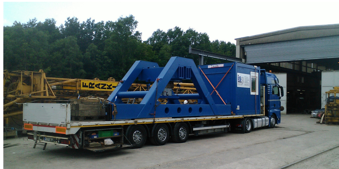
Transport der Probelastungseinheit auf einem Sattelzug mit Standardmaßen
