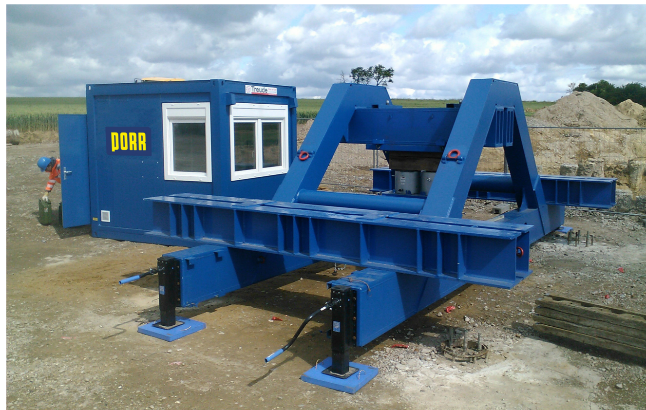
Statische Probelastungseinheit bis 8 MN
